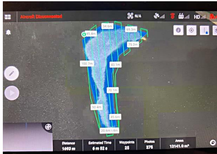
Figur 2. Eksempel på et planlagt survey over Østø i Birksø. Dronen flyver 1693 m i løbet af knapt 7 minutter og tager 275 fotos som dækker et areal på 13141 m 2 .
