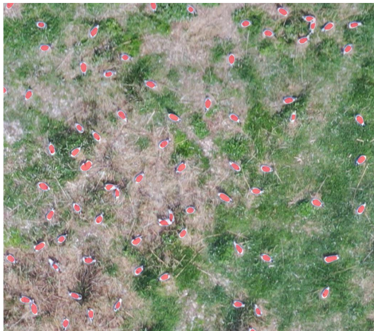
Figur 7. Eksempel på billedbehandlingen af et foto til den halvautomatiske optælling. De røde pletter er et resultatet af billedbehandlingen og udgør en selvstændig farvekanal, der kan optælles af programmet. Kvalitetssikringen består i at sørge for at farvekanalen repræsenterer de fugle man gerne vil have optalt.
