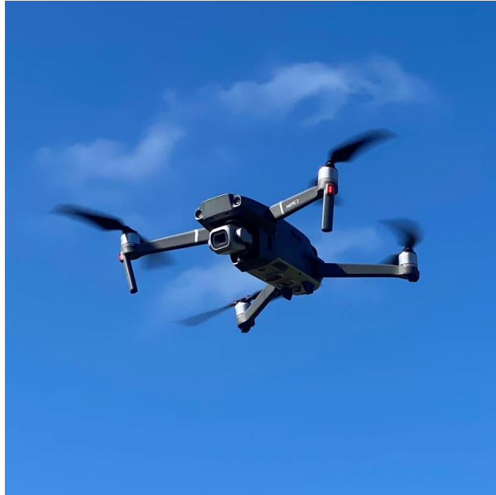
Figur 1. Der blev benyttet en drone af typen DJI Mavic 2 Pro udstyret med et kamera af typen Hasselblad L1D-20c med 20 MB pixels.
